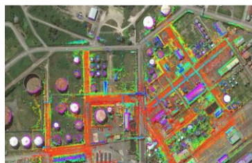
航空写真と整合した 3 次元地図生成
