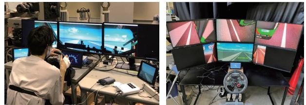
(a)乗用車の遠隔操縦環境 (b)バスの遠隔操縦環境
