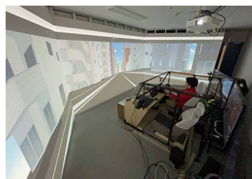
図2 映像投影型ドライビングシミュレータ
