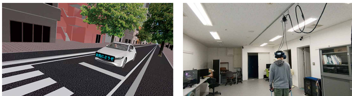
図3 eHMIによる歩行者への情報提示(左)と情報を見て横断する実験参加者(右)
