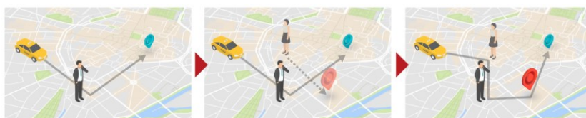
1. デマンドに応じて車両が走行 2. 異なるデマンドが発生 3. リアルタイムにルート最適化
