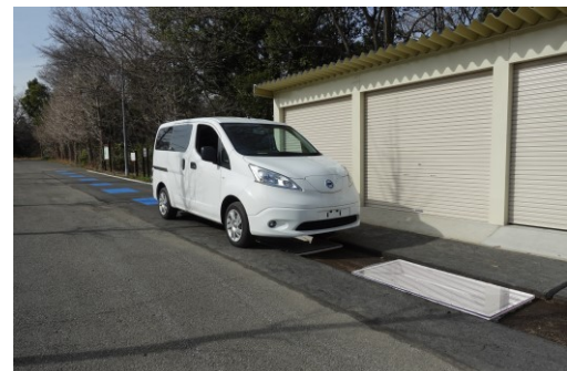
図 走行中ワイヤレス充電のセットアップ (コイル埋設箇所は青ペイントで表示)
