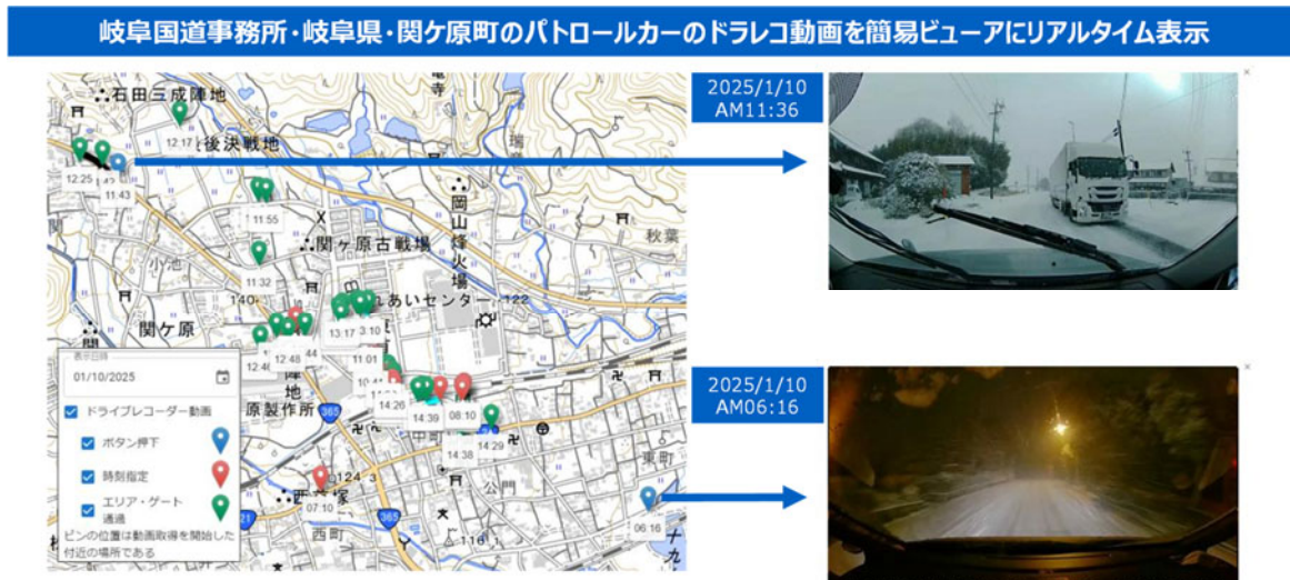
図3-1-2 岐阜県での検証例(ドライブレコーダーデータによる降雪状況の適時的確な把握)
