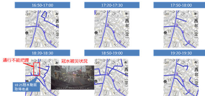
図6-1-2 道路冠水時の通行実績とドライブレコーダー動画
