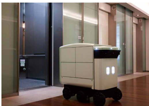
図2 Cartken社 ロボット Model E エレベータ連携の様子
