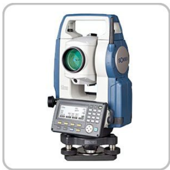
Fig.1 SOKKIA CX-105F (測距距離：1.3～4,000m, 測距精度： \pm(2+2\text{ppm}\times D)\text{mm} , 測角精度：5")
