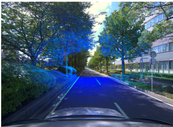
Fig.7 MMS で収集した路面データの点群投影結果
