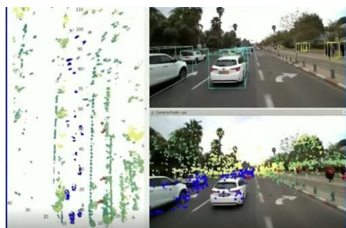
Fig. 2 深層学習による画像認識結果を用いた走行環境の推定結果
