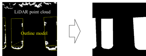
LiDAR 点群と車両形状輪郭モデル 生成された正解形状
