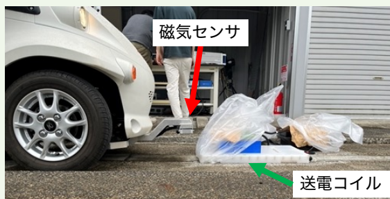
磁気センサと送電コイルを用い、送電による磁気センサへの影響を調査した
